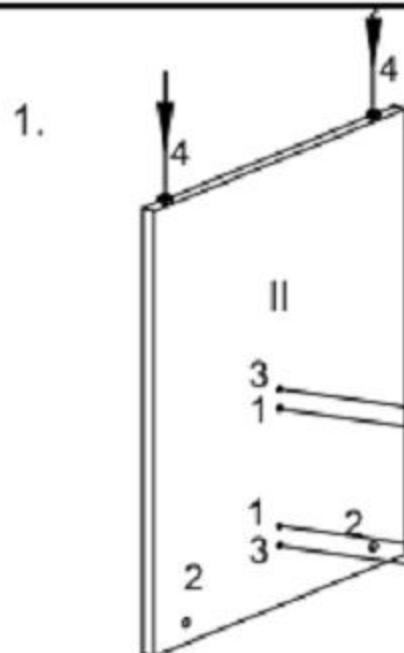
Положить боковины и переднюю панель отверстиями вверх. Забить в боковины регулируемые опоры с крепежем(4). Забить в боковины шканты (1) и вкрутить дюбеля стяжек-эксцентриков (3). Вставить в боковины и переднюю панель стяжки-эксцентрики (2) стрелкой в направлении отверстия на торце. Соединить боковины с передней панелью. Стянуть каркас, поворачивая стяжки-эксцентрики (2) на передней панели с помощью отвертки.
